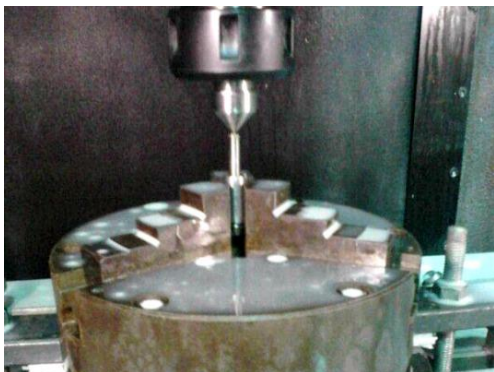
Figura 3. Centralização por furo de centro
